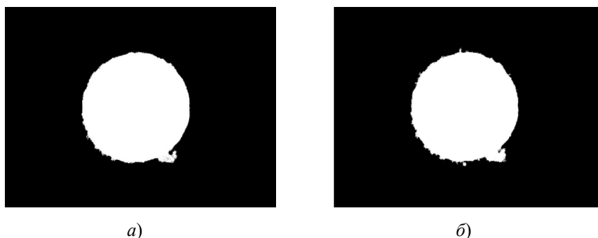
Рис. 2. Изображения тестового фрагмента круглой формы, полученные с помощью микроскопа DigiMicroProf : а – без вибрационного размытия; б – с вибрационным размытием
